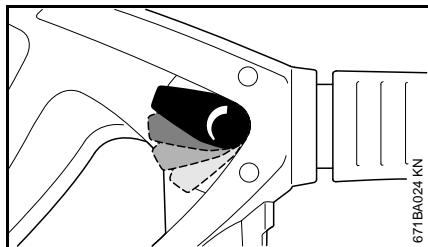
Przy pomocy dźwigni nastawczej można dokonywać precyzyjnej stopniowej regulacji ciśnienia roboczego oraz wielkości przepływu wody.
