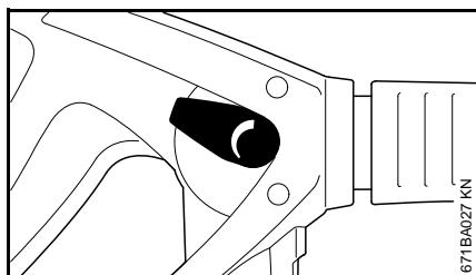
Dźwignia nastawcza w pozycji standardowej: maksymalne ciśnienie robocze oraz ilość wody.
