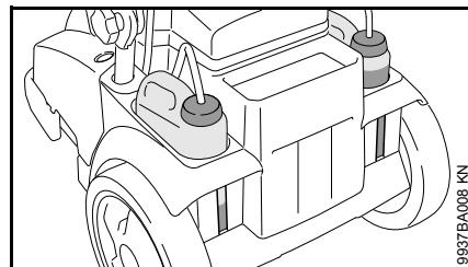
Уровень заполнения каждой емкости можно считать через выемки в корпусе.
